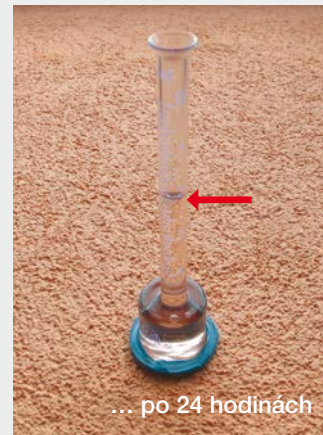
Test nasiakavosti na bežnej konkurenčnej silikónovej omietke
