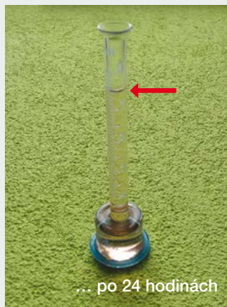
Test nasiakavosti PCI Multiputz® NoBio Z
