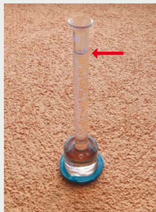
Test nasiakavosti na bežnej konkurenčnej silikónovej omietke
