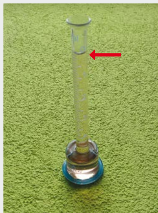
Test nasiakavosti PCI Multiputz® NoBio Z
